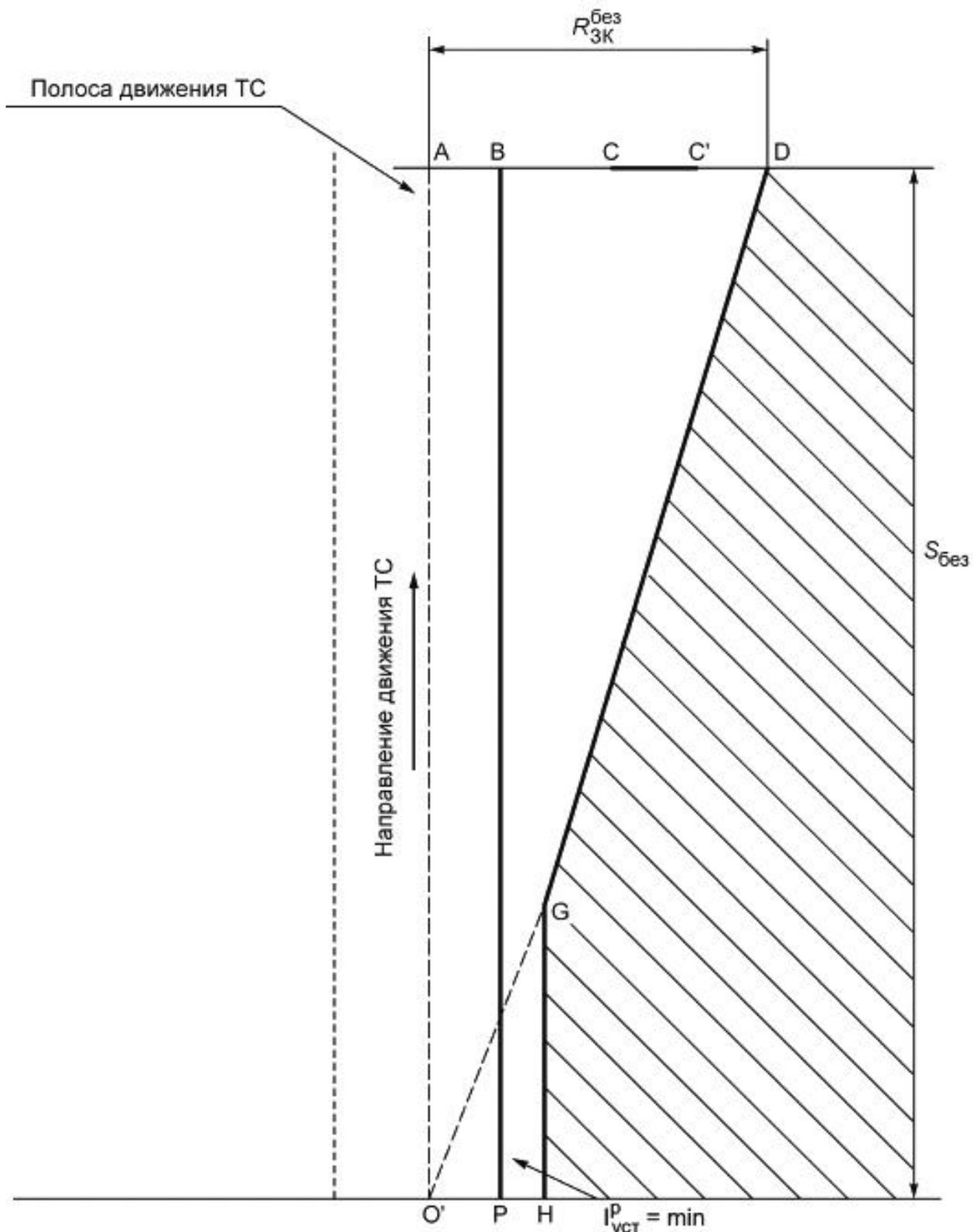
DGH - границы коридора безопасности; PB - край проезжей части; O' - транспортное средство; CC' - дорожный знак (светофор), предусмотренный Г.3.1, Г.3.2;  $R_{3К}^{без}$  - минимальное расстояние от середины крайней полосы движения, определяемое по формуле (Г.2), при котором обеспечивается видимость дорожного знака, предусмотренного Г.3.1, Г.3.2.
