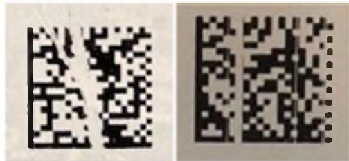
Нарушение целостности КМ*
