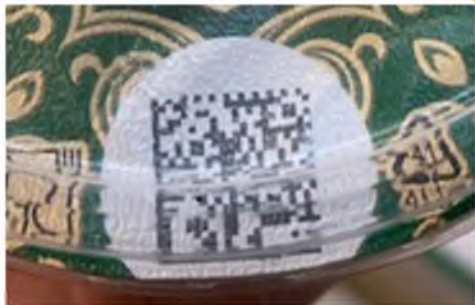
Отсутствие ровного рельефа
