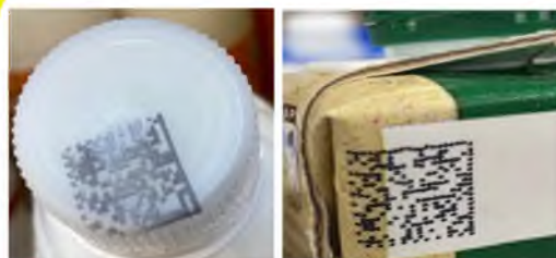
Смещение кода маркировки при печати
