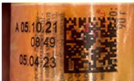
Печать кода маркировки на бликующей/светоотражающей поверхности
