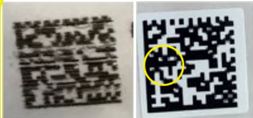
Смазывание кода маркировки или его отдельных элементов
