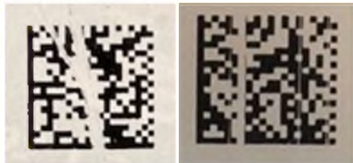
Нарушение целостности КМ*
